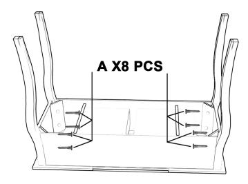
USE SCREWS A(X8PCS) TO ATTACH THE TABLE BODY (13) TO THE TABLE LEGS(8)
