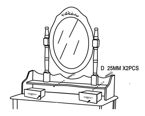
INSTALL THE SMALL DRAWER(6) TO THE POSITION SHOWN USING SCREWS D(X2PCS)
